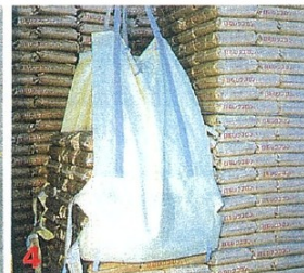
到着後、つりベルトを掛けて荷下ろししたあと荷ほどきベルトに掛けかえて引き上げると荷物の中の荷姿のままそっくり抜けます。
