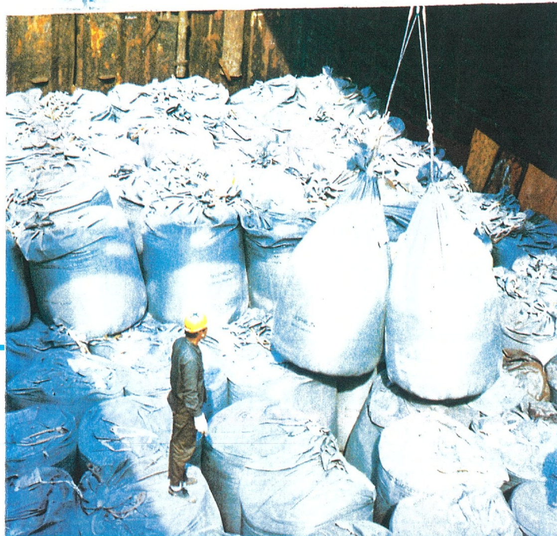
到着後、つりベルトを掛けて荷下ろししたあと荷ほどきベルトに掛けかえて引き上げると荷物の中の荷姿のままそっくり抜けます。
