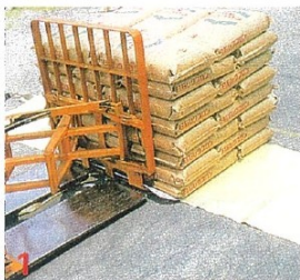
荷物をオープンコンテナ上に移します。
