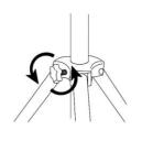
脚幅の調整ができたら、 上部のネジを締めます。
