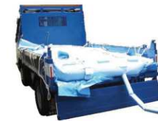
車載積載用飲料水タンク M-2 型 (1000L)
